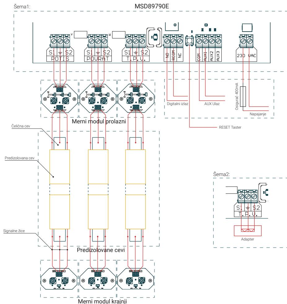
Na crtežu "Šema 1" je prikazan način povezivanja trocevnog sistema. U slučaju povezivanja dvocevnog sistema, na treći kanal se stavlja "Adapter" koji služi da simulira neometan rad na tom kanalu kao što je prikazano na crtežu "Šema 2".
