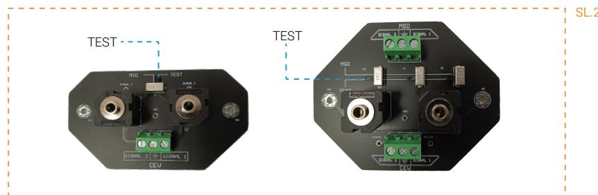
Pri kontrolnom merenju, uređaj vezati na testni konektor (**J1 ili J2**) kablom od 3.5mm sa konektorom impedanse  $220 \Omega$ , kao što je prikazano na (SL.3). U tom trenutku su sve kontrolne žice u predizolovnim cevima odvojene od sistema i može se vršiti merenje od jedne do druge merne kutije.
