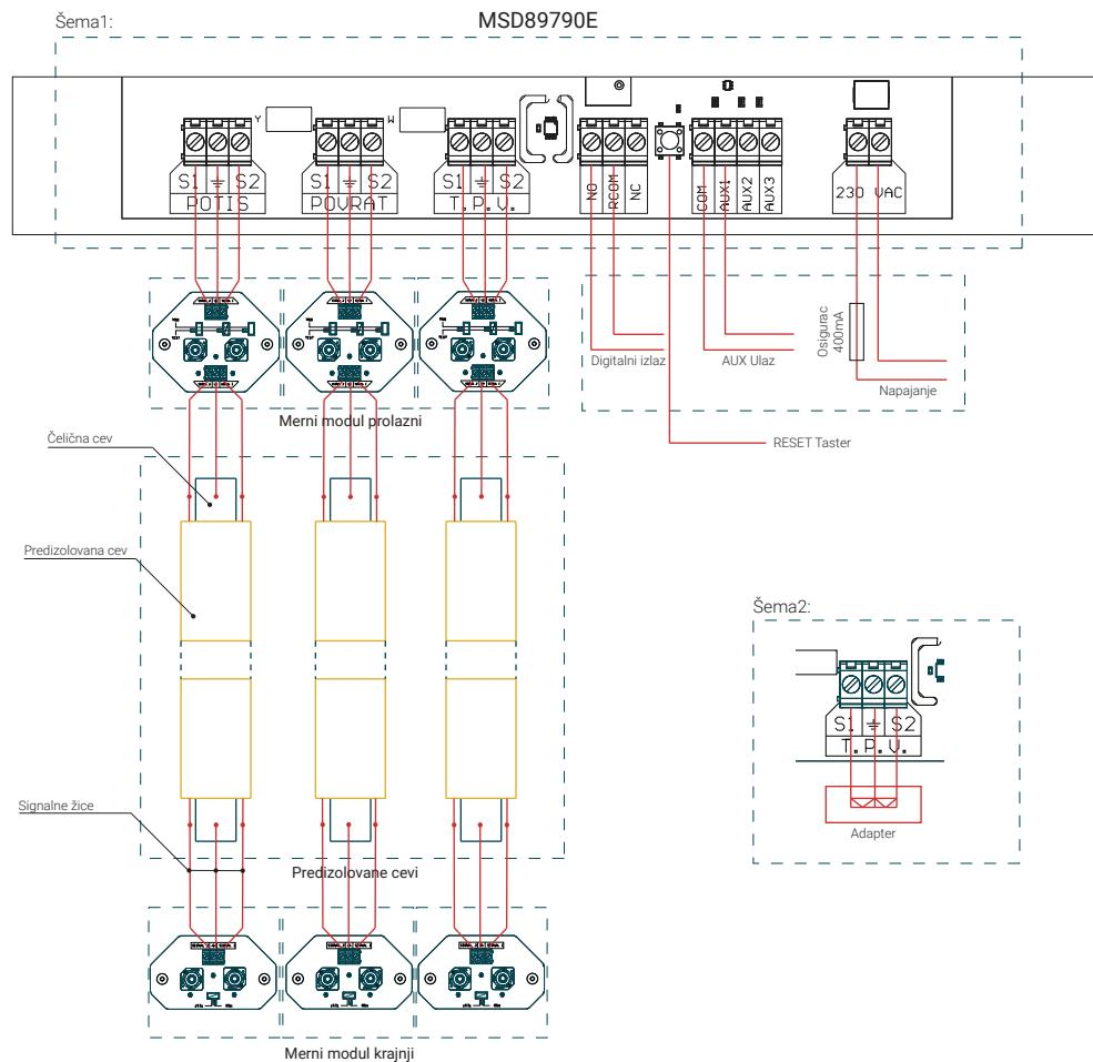
Na crtežu "Šema 1" je prikazan način povezivanja trocevnog sistema. U slučaju povezivanja dvocevnog sistema, na treći kanal se stavlja "Adapter" koji služi da simulira neometan rad na tom kanalu kao što je prikazano na crtežu "Šema 2".
