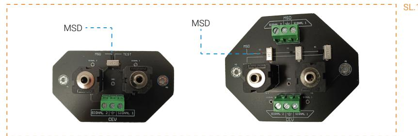
U slučaju da se vrši kontrolno merenje prenosnim uređajem, svi prekidači (**S1, S2, S3**) se prebacuju na TEST poziciju. (SL.2)
