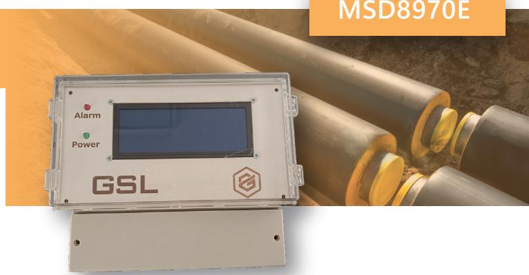
Detektor curenja predizolovanih cevi **MSD8970E** je elektronski instrument koji služi za detekciju curenja, kao i za proveru postavljanja i povezanosti signalnih žica za dojavu kod predizolovanih toplovođa (sistema). Uredaj je dizajniran za stacionarnu instalaciju. Povezuje se na žice za dojavu i cev za protok fluida i vrši kontinualni monitoring tri alarmna stanja:
